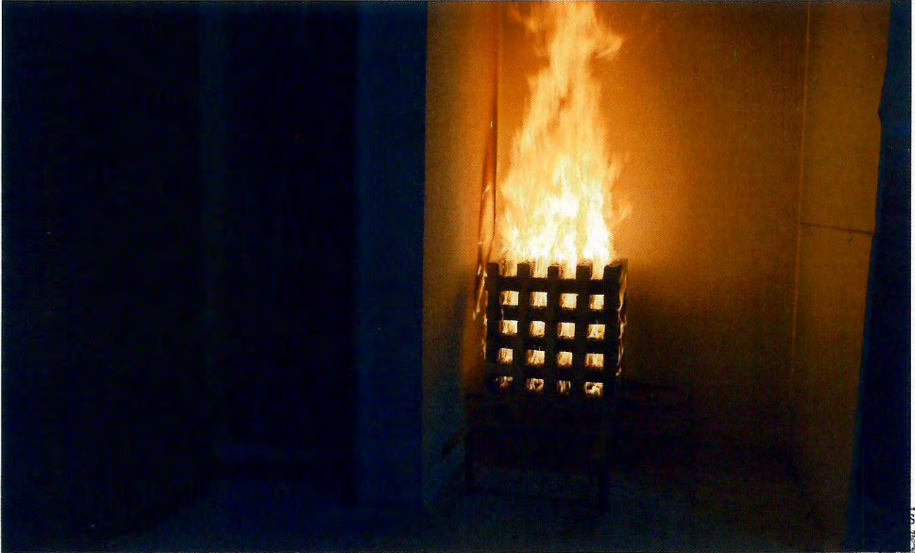
Bild 3: Prüfkörper während des Brandversuches (8 Minuten Versuchsdauer)
