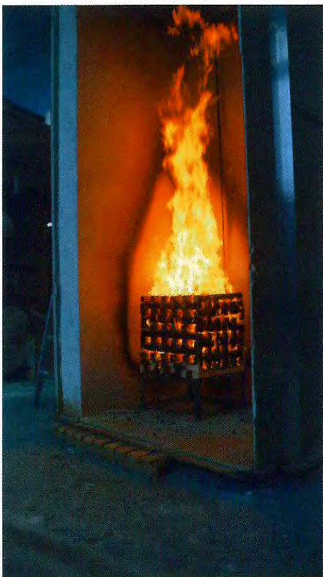
Bild 6: Prüfkörper während des Brandversuches (16 Minuten Versuchsdauer)
