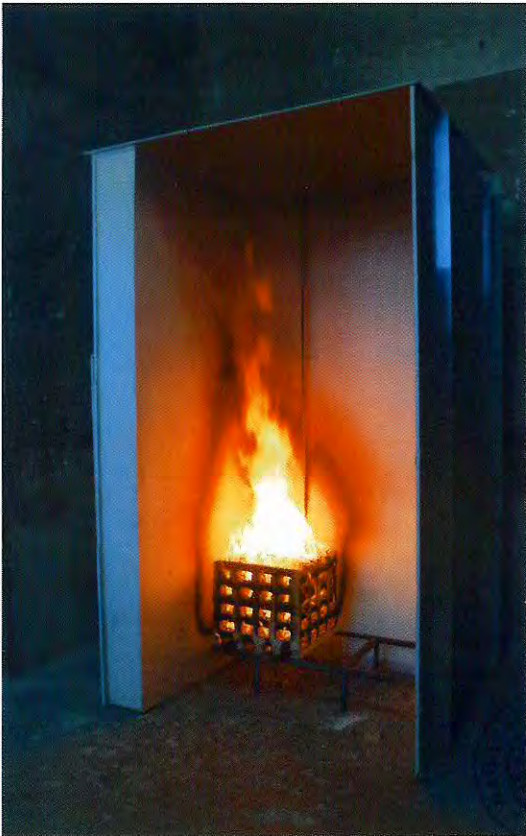
Bild 5: Prüfkörper während des Brandversuches (10 Minuten Versuchsdauer)
