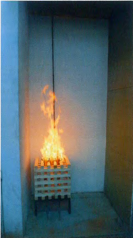
Bild 3: Prüfkörper während des Brandversuches (3 Minuten Versuchsdauer)
