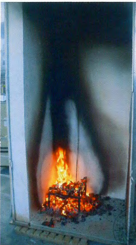
Bild 8: Prüfkörper während des Brandversuches (28 Minuten Versuchsdauer)
