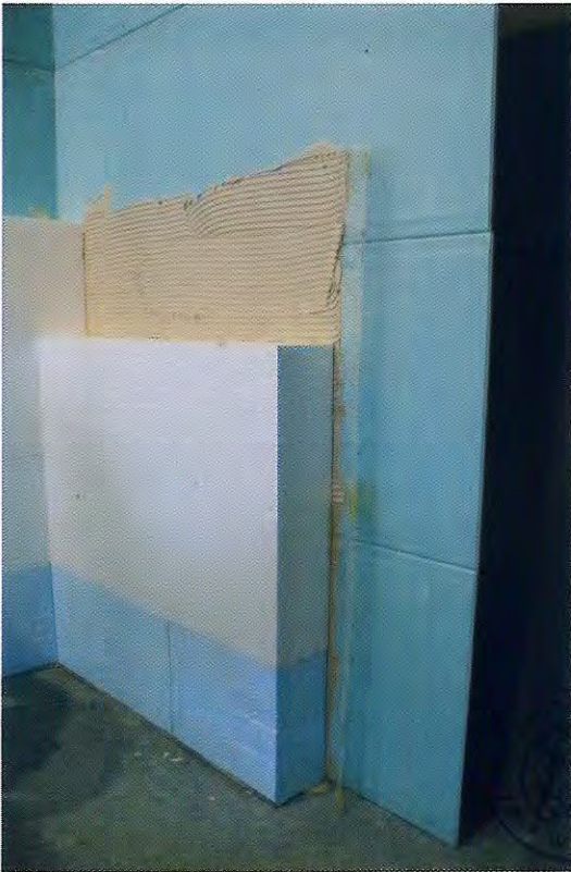
Bild 1: Montage des Prüfkörpers am Prüfstand
