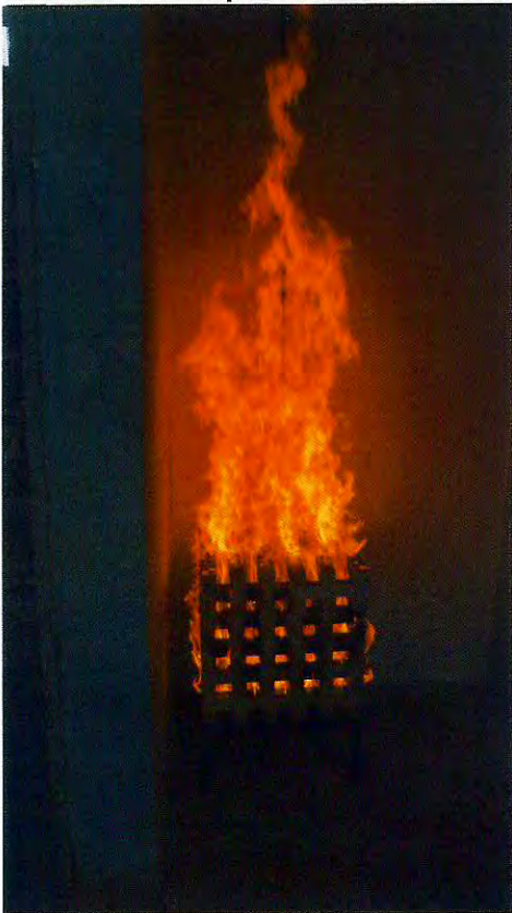
Bild 4: Prüfkörper während des Brandversuches (3 Minuten Versuchsdauer)
