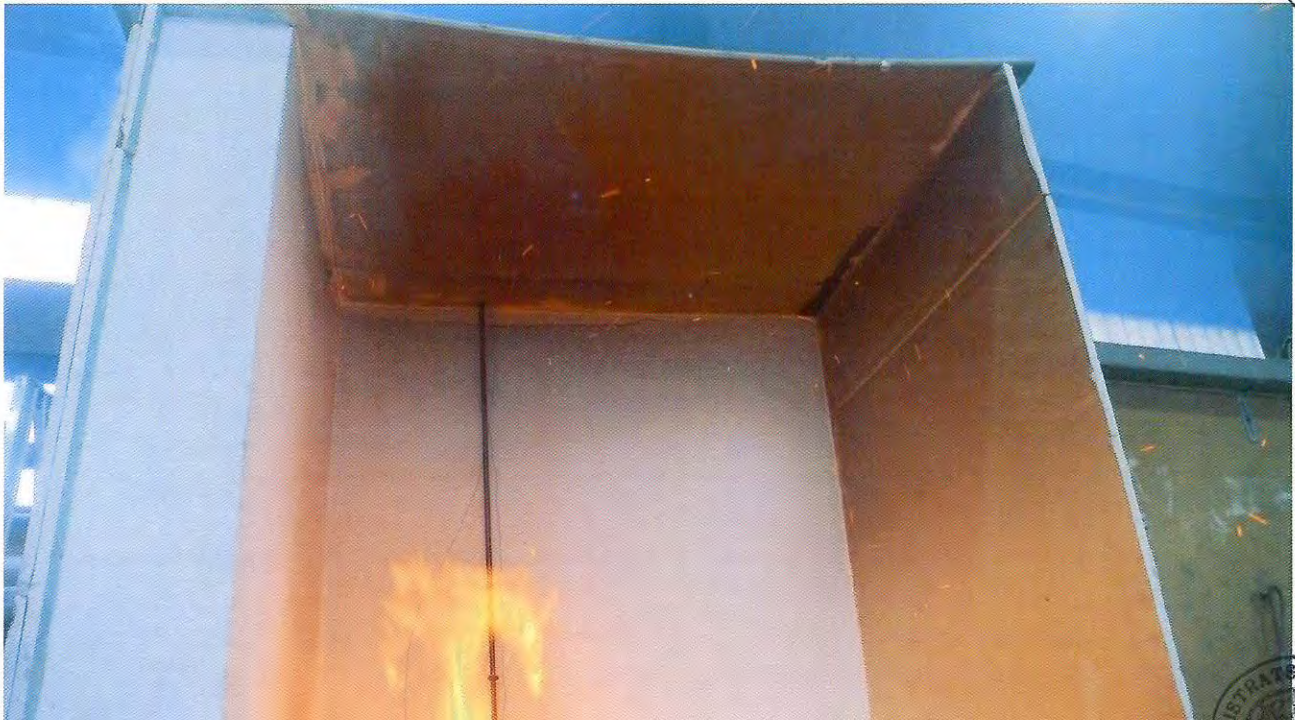
Bild 5: Prüfkörper während des Brandversuches (11 Minuten Versuchsdauer)
