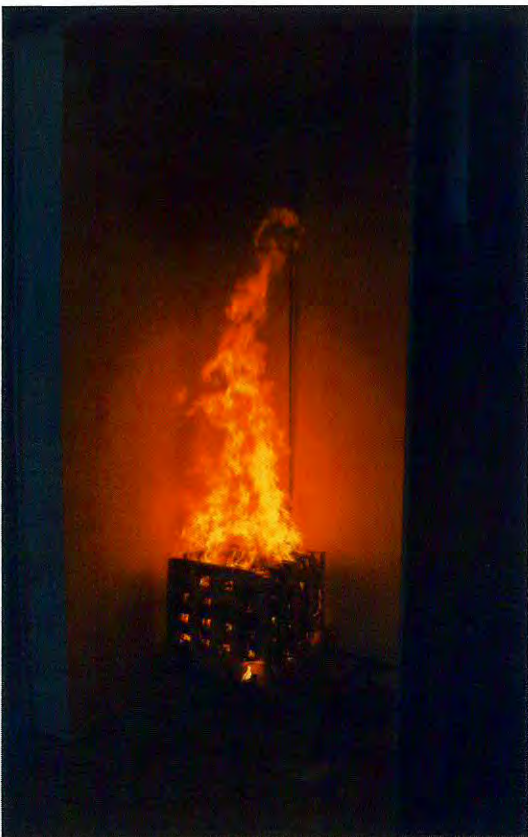
Bild 4: Prüfkörper während des Brandversuches (3 Minuten Versuchsdauer)
