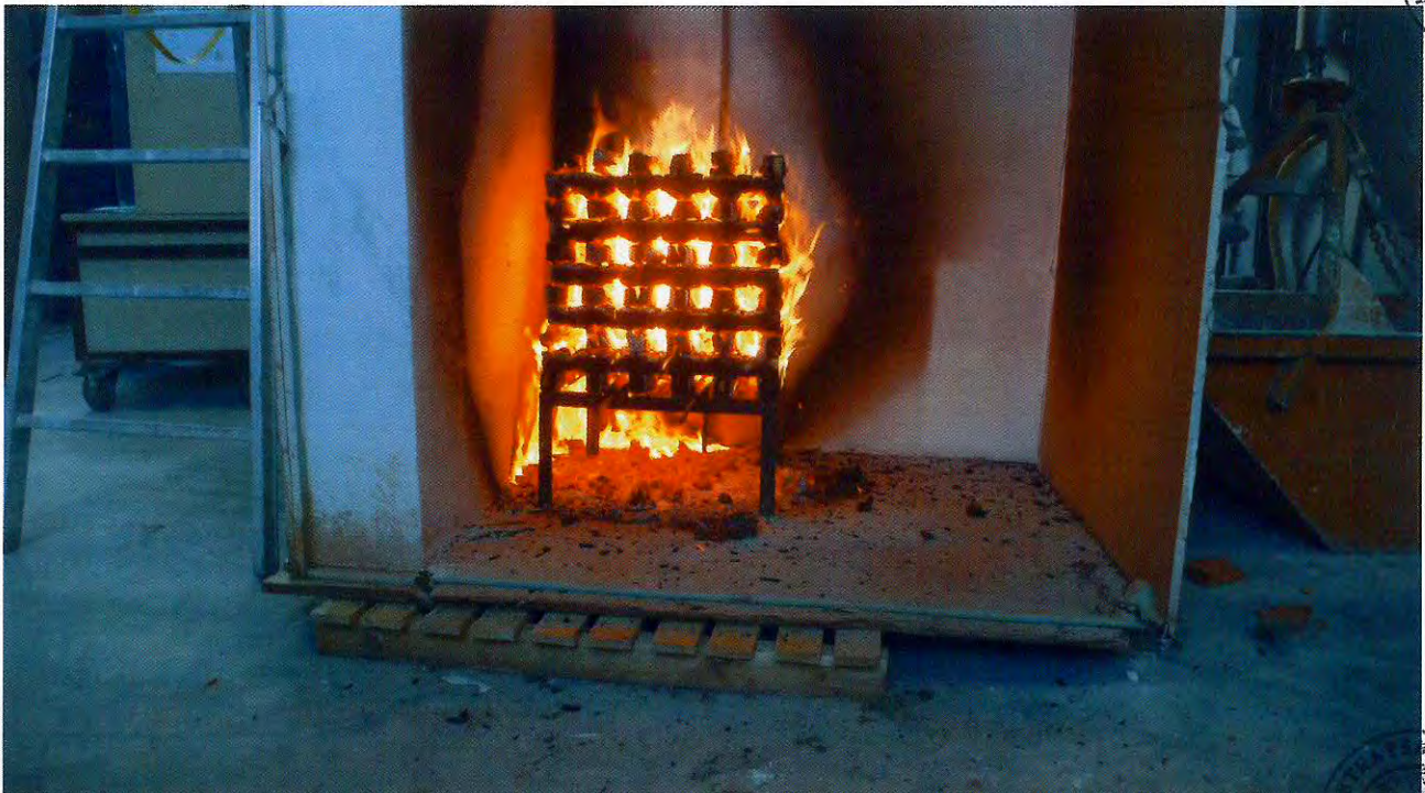
Bild 7: Prüfkörper während des Brandversuches (23 Minuten Versuchsdauer)
