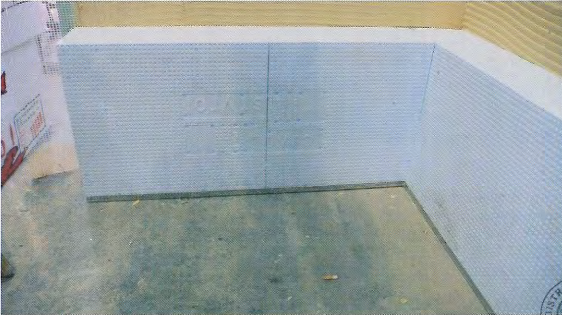
Bild 1: Montage des Prüfkörpers am Prüfstand
