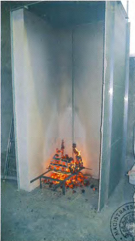
Bild 5: Prüfkörper während des Brandversuches (28 Minuten Versuchsdauer)
