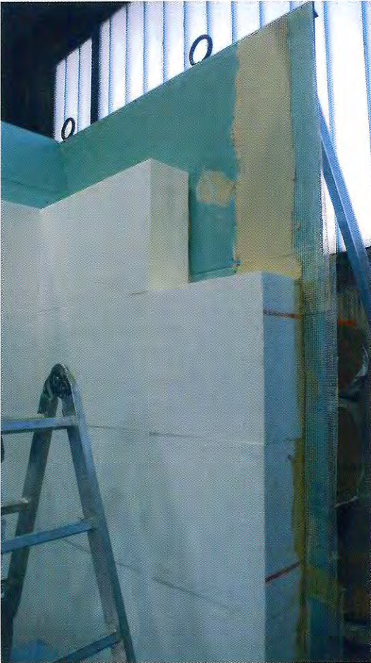
Bild 2: Montage des Prüfkörpers am Prüfstand
