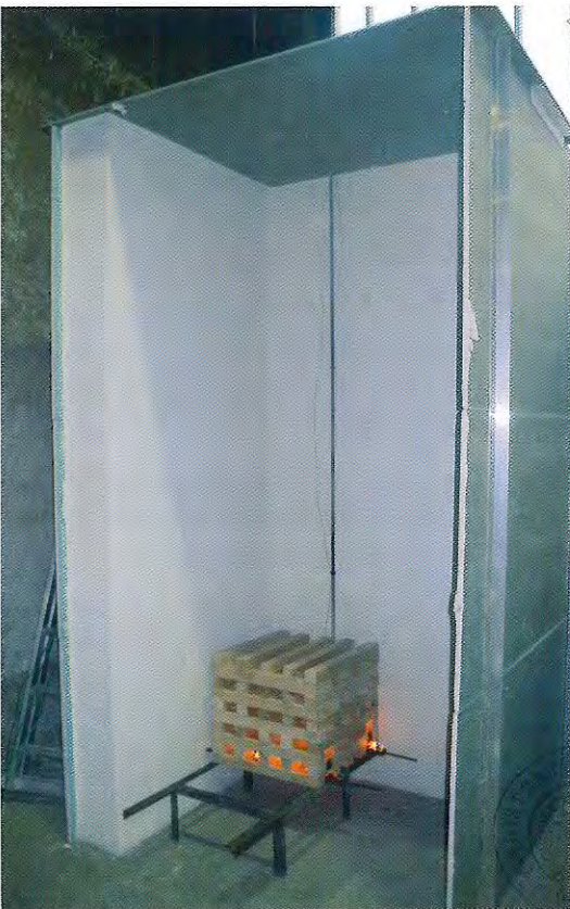
Bild 2: Prüfkörper während des Brandversuches (1 Minuten Versuchsdauer)
